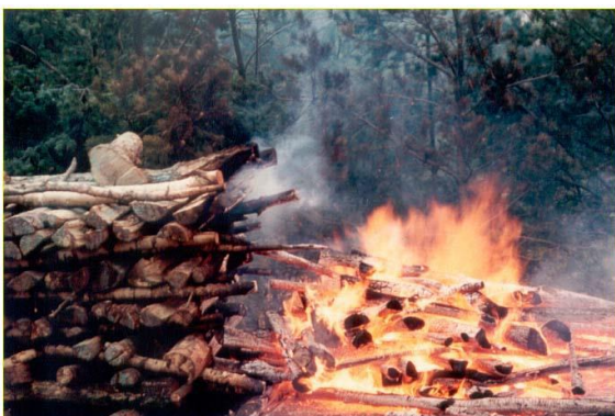
Abb. 1 Linke Seite des Holzstapels mit HYDREX geschützt
